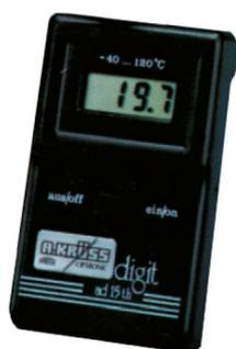
Thermomètre pour réfractomètre d'Abbe
