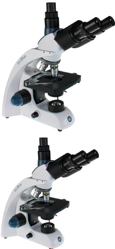
Objectifs SMP 1000 x et Platine à déplacement X-Y Tête : Trinoculaire inclinée à 45°, tournante sur 360° Objectifs : SEMI-Plans Achromatiques DIN 4x/ 0.10, 10x/0.25, S40x/0.65, S100x/1.25 Objectifs 40x Rétractable et 100x à Immersion à Huile. Eclairage : à Diode électroluminescente LED de 1 Watt avec intensité réglable, batterie intégrée rechargeable et alimentation externe sur transformateur inclus.
