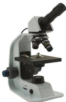
Tête : monoculaire Objectifs : 4x, 10x, 40x et 100x Platine : 25 x 116 mm avec surplatine à déplacements XY 76 x 30 mm Alimentation secteur externe
